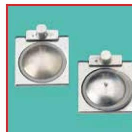
Rechts: Undichtes Klappenventil eines Trokars durch Aufquellung der Dichtung als Folge von Ölkontakt.
