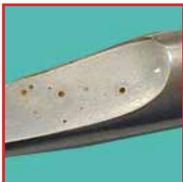
Chloridinduzierte Lochkorrosion auf dem Instrument.
