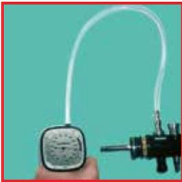
Manueller Dichtetest bei einem flexiblen Endoskop
