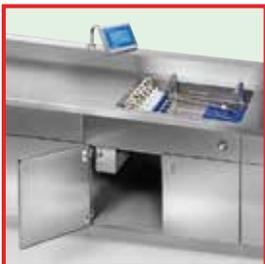
Ultraschallgerät, in Arbeitsbereich eingebaut
