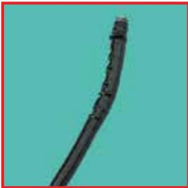
Aufquellung am Distalende eines Fiberskops
